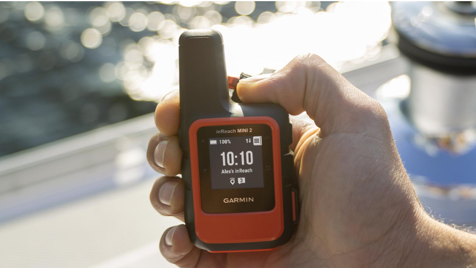
Das inReach Mini 2 ist ein leichtes und kompaktes GPS-Satelliten-Kommunikationsgerät von Garmin mit Notruf-Funktion.
